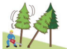
(図 4) かかり木に激突させるためにかかり木以外の立木の伐倒
