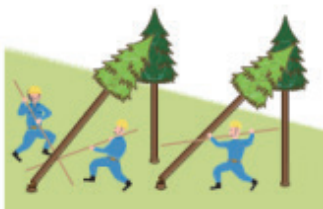
(図 2) かかり木の処理
